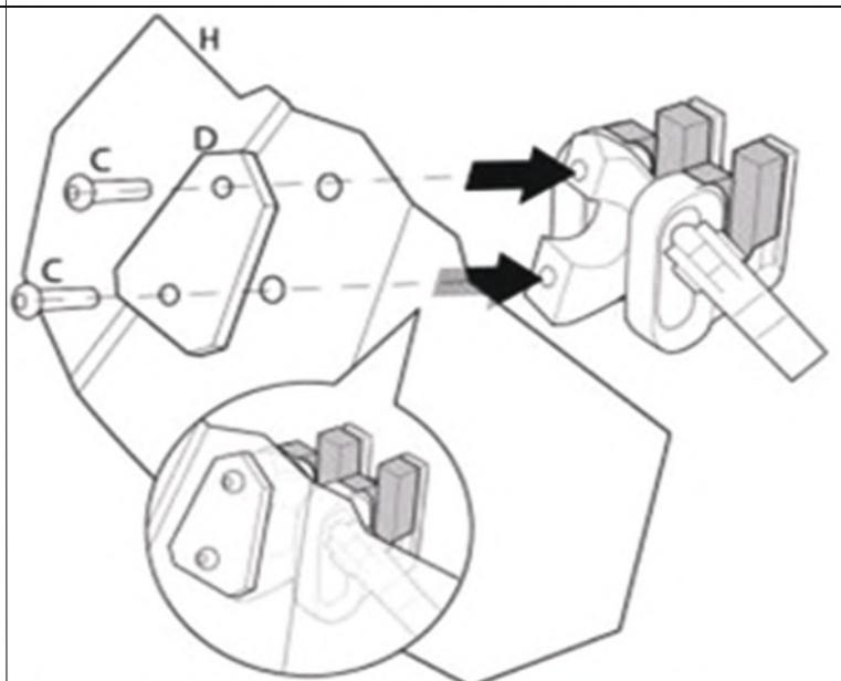
Bevestig de metalen plaat (D) aan het glas en draai de inbusbouten vast in het koppelstuk.
