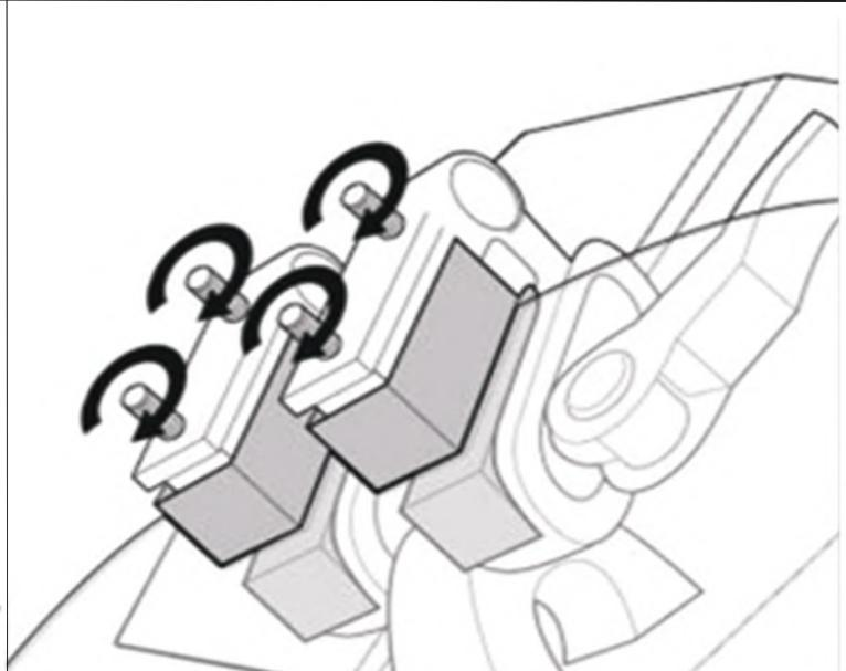
Draai de bouten aan zodat het strak op het glas vast zit, uw glas wordt niet beschadigd dankzij de siliconen kussentjes.
